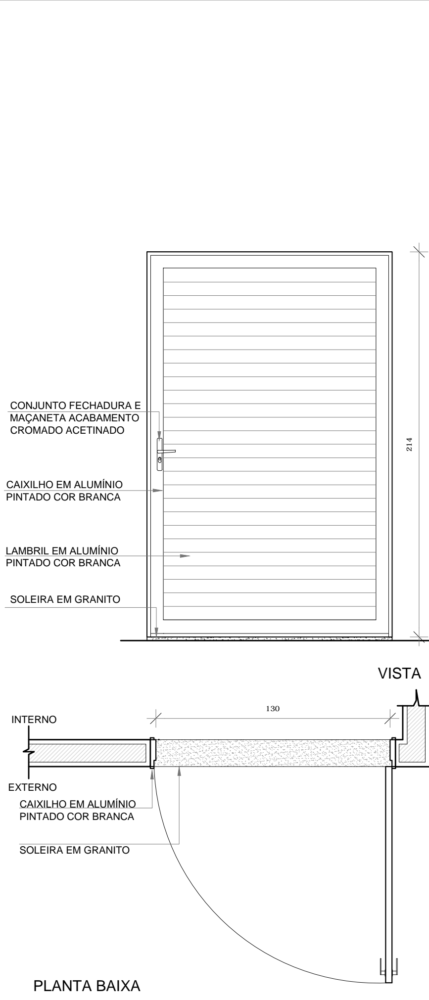
PA2 QUANT.: 01 DIMENSÕES: 130 x 210 cm SISTEMA: de abrir e alumínio AMBIENTES: - Porta de acesso
