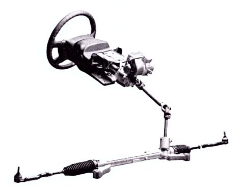
Quanto à direção hidráulica, o principal objetivo dessa direção é facilitar a condução do veículo, permitindo ao motorista uma redução na força aplicada sobre o
