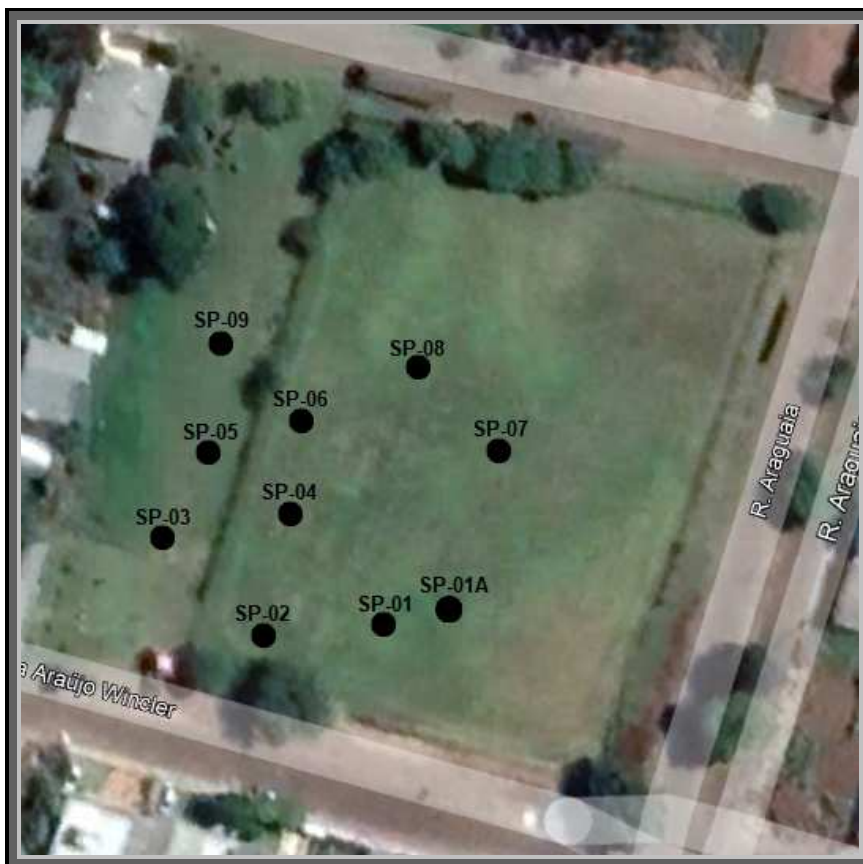
Figura 3. Croqui com a locação das sondagens executadas.
