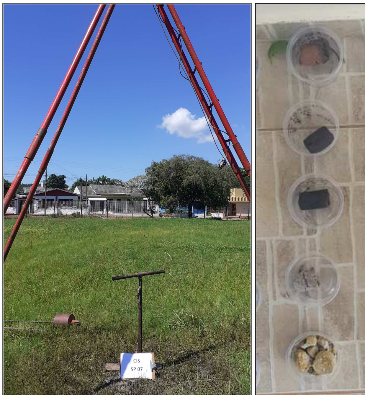
Figura 11. Registro fotográfico da execução da sondagem SP-07.
