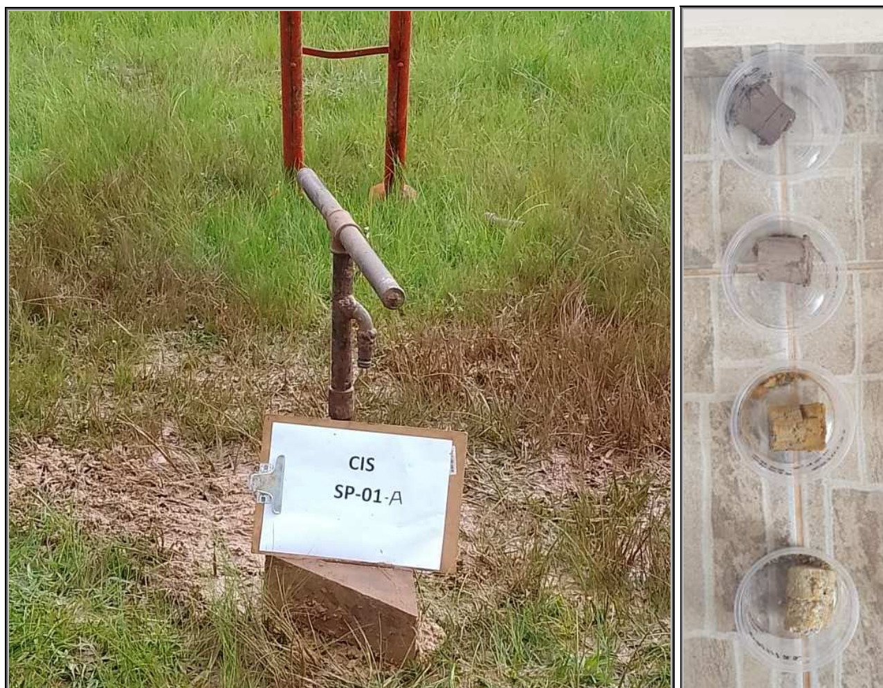
Figura 5. Registro fotográfico da execução da sondagem SP-01A.
